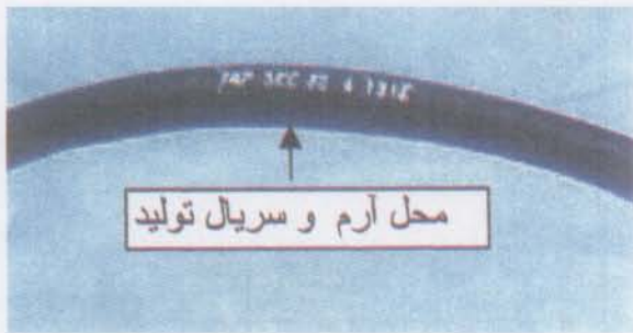
تصویر قطعه معرف محل و چگونگی درج تاریخ تولید
