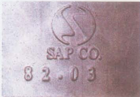
تصویر قطعه معرف محل و چگونگی درج تاریخ تولید
