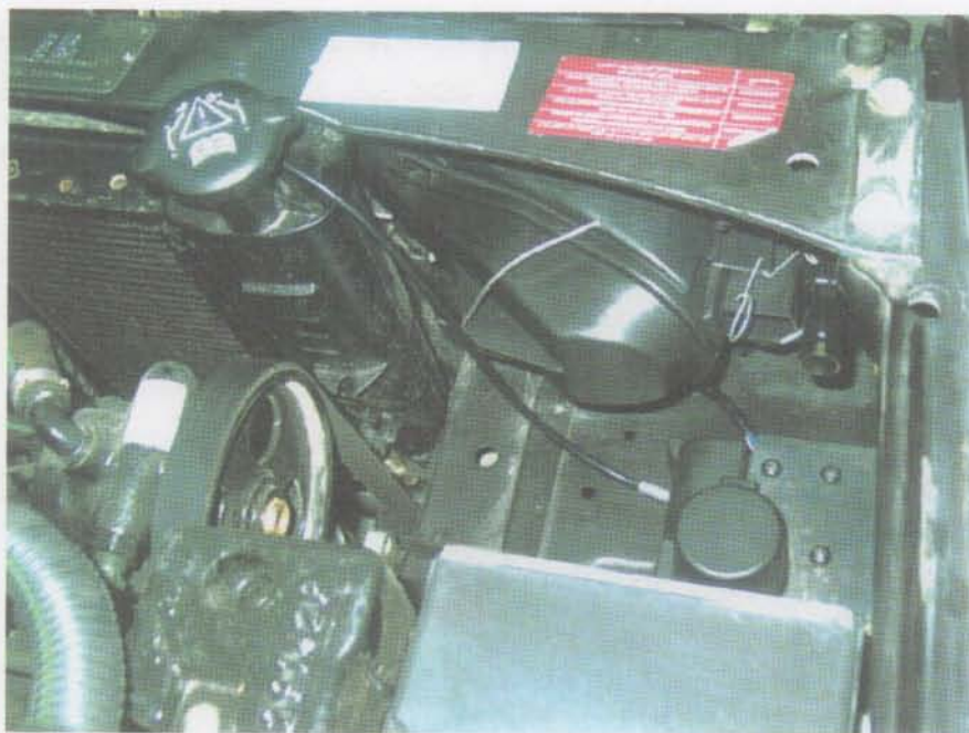
شکل ۱۳- محل نصب عملگر الکتریکی و مسیر عبور کابل عملگر
